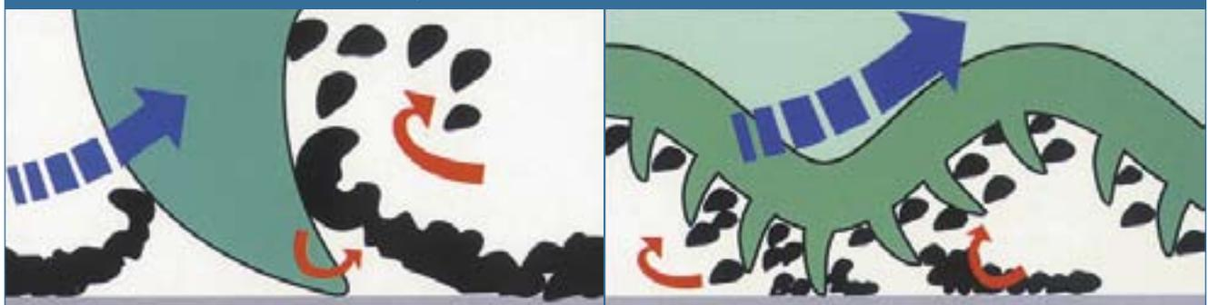
**Der Schmutzbelag wird nicht abgeschliffen, sondern aufgebrochen und von der wellenförmigen Oberfläche abgetragen – ohne zu kratzen!\***
